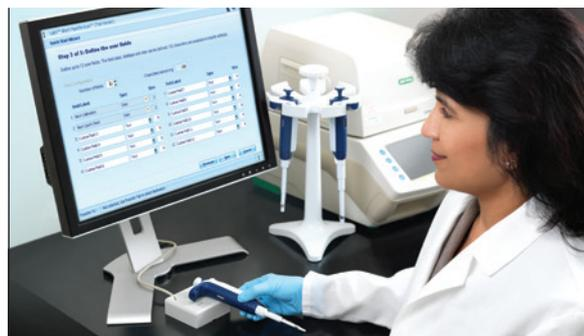
Le lecteur RFID en option, pour toutes les pipettes avec fonction Rainin RFID, établit une interface avec le logiciel LabX™ pour le contrôle d'étalonnage de Pipette-Scan™ de METTLER TOLEDO.
